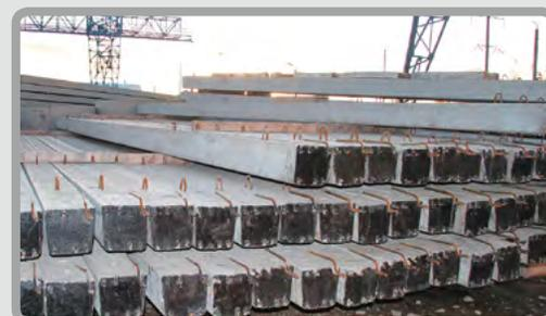
**СТОЙКА ЖЕЛЕЗОБЕТОННАЯ ВИБРИРОВАННАЯ
